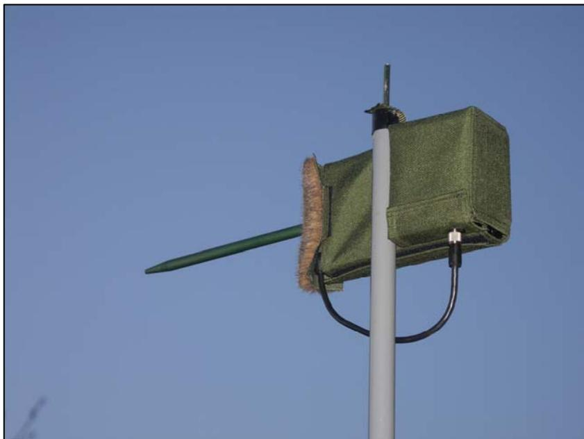
**Abb. 1** Automatische Registriereinheit („batcorder“, ecoObs, Nürnberg).
